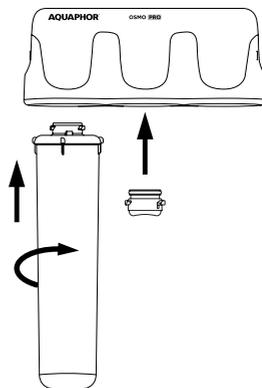
**ПРИМЕЧАНИЕ.** На этом этапе устанавливать мембранный модуль не нужно. Для проведения промывки фильтра ввинтите в среднее гнездо коллектора промывочную заглушку.
